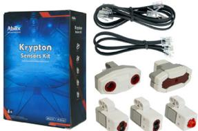
**BAP199** **Sensors Pack** - kit contiene 5 sensori (10 componenti): 1 Ultrasonic, 1 color, 1 grayscale, 1 Camera, 1 Collision, 5 cavi
